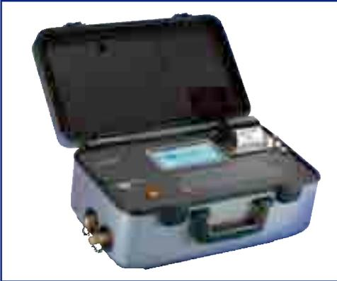
Contatore di particelle calibrato secondo ISO 11171, pressione di lavoro da 2 bar (28 psi) a 400 bar (5715 psi). Dati di contaminazione in accordo con alla normativa ISO 4406, NAS 1638 e AS4059. Sensori per la rilevazione della temperatura e dell'umidità residua nell'olio.
