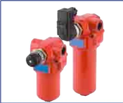
Filtro in linea pressione di lavoro 110 bar (1570 psi) portata fino a 90 l/min (24 gpm) connessioni filettate da 1/2" BSP/NPT/SAE.
