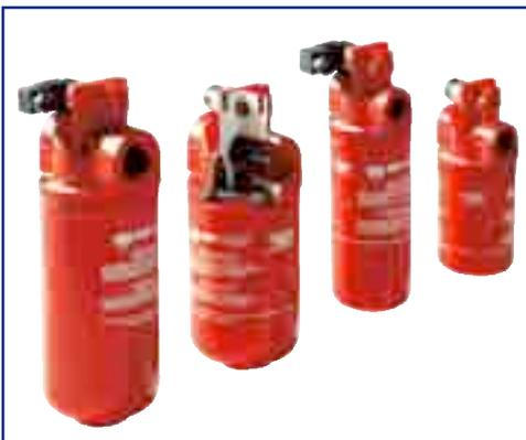
Filtro in linea Spin-On pressione di lavoro 35 bar (508 psi) portata fino a 300 l/min (80 gpm) connessioni filettate da 3/4" e 1 1/2" BSP/NPT/SAE.
