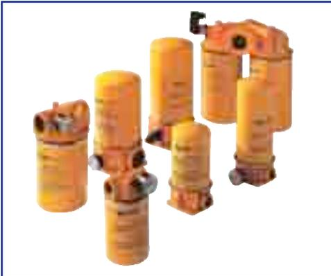
Filtro in aspirazione - linea - ritorno Spin-On pressione di lavoro 12 bar (174 psi) portata fino a 300 l/min (80 gpm) connessioni filettate da 3/4" e 1 1/2" BSP/NPT/SAE e flangiate 1 1/2" SAE 3000 PSI.
