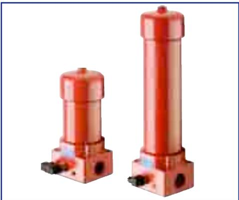
Filtro in linea pressione di lavoro 350 bar (5000 psi) portata fino a 500 l/min (133 gpm) connessioni filettate 1 1/2" BSP/NPT/SAE e flangiate 2" SAE 6000 PSI a piastra.
