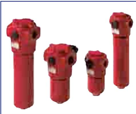
Filtro in linea pressione di lavoro 280 bar (4000 psi) portata fino a 475 l/min (126 gpm) connessioni filettate fino a 1 1/2" BSP/NPT/SAE e flangiate fino a 1 1/2" SAE 3000 PSI.
