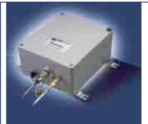
Contatore di particelle in esecuzione fissa calibrato secondo ISO 11171, pressione di lavoro da 2 bar (28 psi) a 400 bar (5715 psi). Dati di contaminazione in accordo alla normativa ISO 4406, NAS 1638 e AS16666. Sensori per la rilevazione della temperatura e dell'umidità residua nell'olio. Programmazione tramite PC o PLC.
