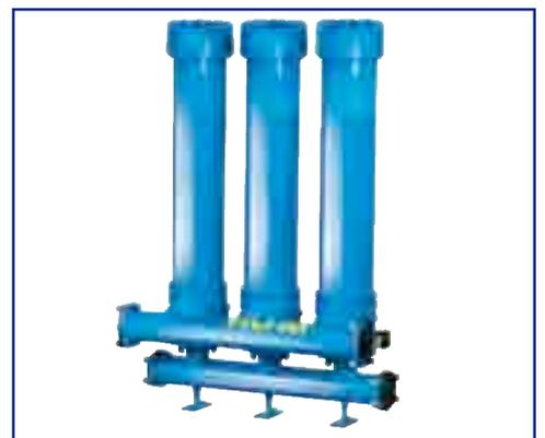
Filtro in linea modulare da 2 a 6 corpi pressione di lavoro 25 bar (358 psi) portata fino a 1200 l/min (315 gpm) flangiate 3" e 4" SAE 3000 PSI/DIN PN 16.
