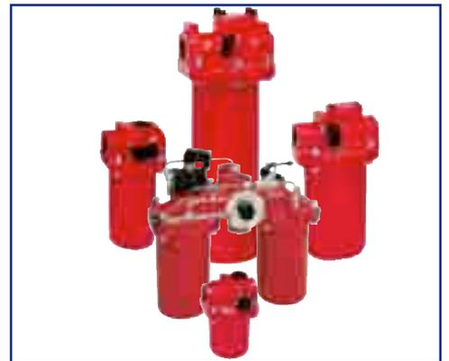
Filtro in linea pressione di lavoro 40 bar (570 psi) portata fino a 2500 l/min (660 gpm) connessioni filettate da 1 1/2" e 2" BSP/NPT/SAE e flangiate fino a 4" SAE 3000 PSI.
