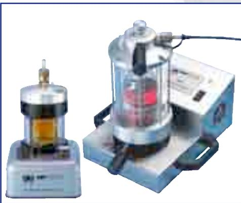
Accessori da utilizzare in abbinamento ai contatori LPA 2 PML per le analisi statiche degli oli disponibili per contenitori da 110 ml o 250 ml.
