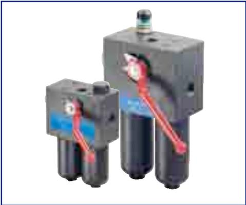
Filtro in linea doppio pressione di lavoro 350 bar (5000 psi) portata fino a 345 l/min (92 gpm) connessioni filettate 1 1/4" BSP/NPT/SAE e flangiate 1 1/2" SAE 6000 PSI.
