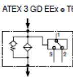
SPDT С.С. 14 - 30 В: > Макс. резистивная или индуктивная нагрузка 3 - 1 А соответственно
