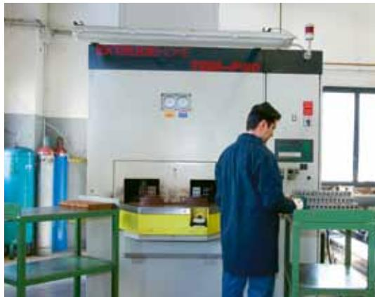
Dal 2003 l'Oleodinamica Marchesini può vantare la presenza di un moderno impianto di sbavatura termica **TEM** a cui sottopone tutti i corpi valvola prima di essere inviati al trattamento di zincatura.
