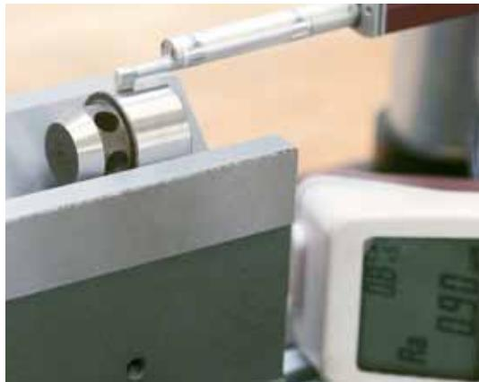
Prima di essere inviati alle successive fasi di lavorazione, un campione significativo di semilavorati viene sottoposto a severi **controlli** (dimensione, durezza, proiezione dei profilo, ecc.).
