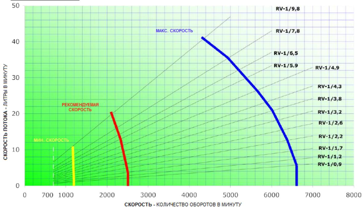
Примечание: Делитель потока может работать и при скорости ниже минимальной, но его КПД будет ниже.
