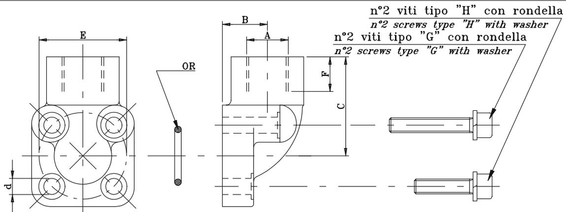
**RACCORDI A GOMITO IN ACCIAIO (per connessioni tipo "T")**
