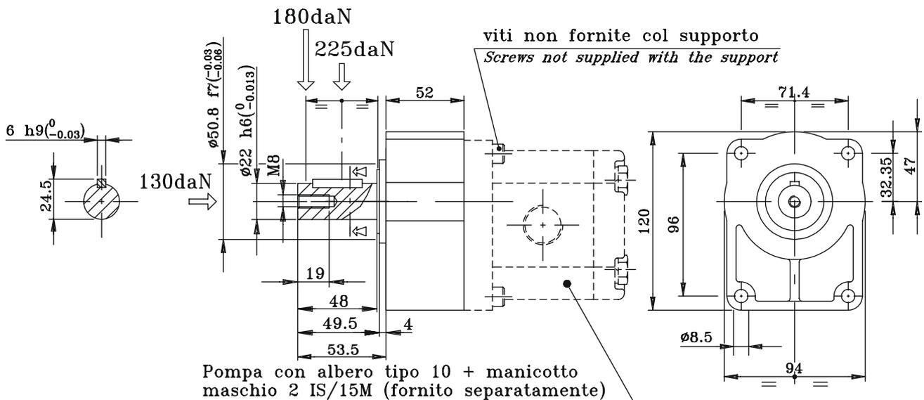
Pompa con albero tipo 10 + manicotto maschio 2 IS/15M (fornito separatamente)
