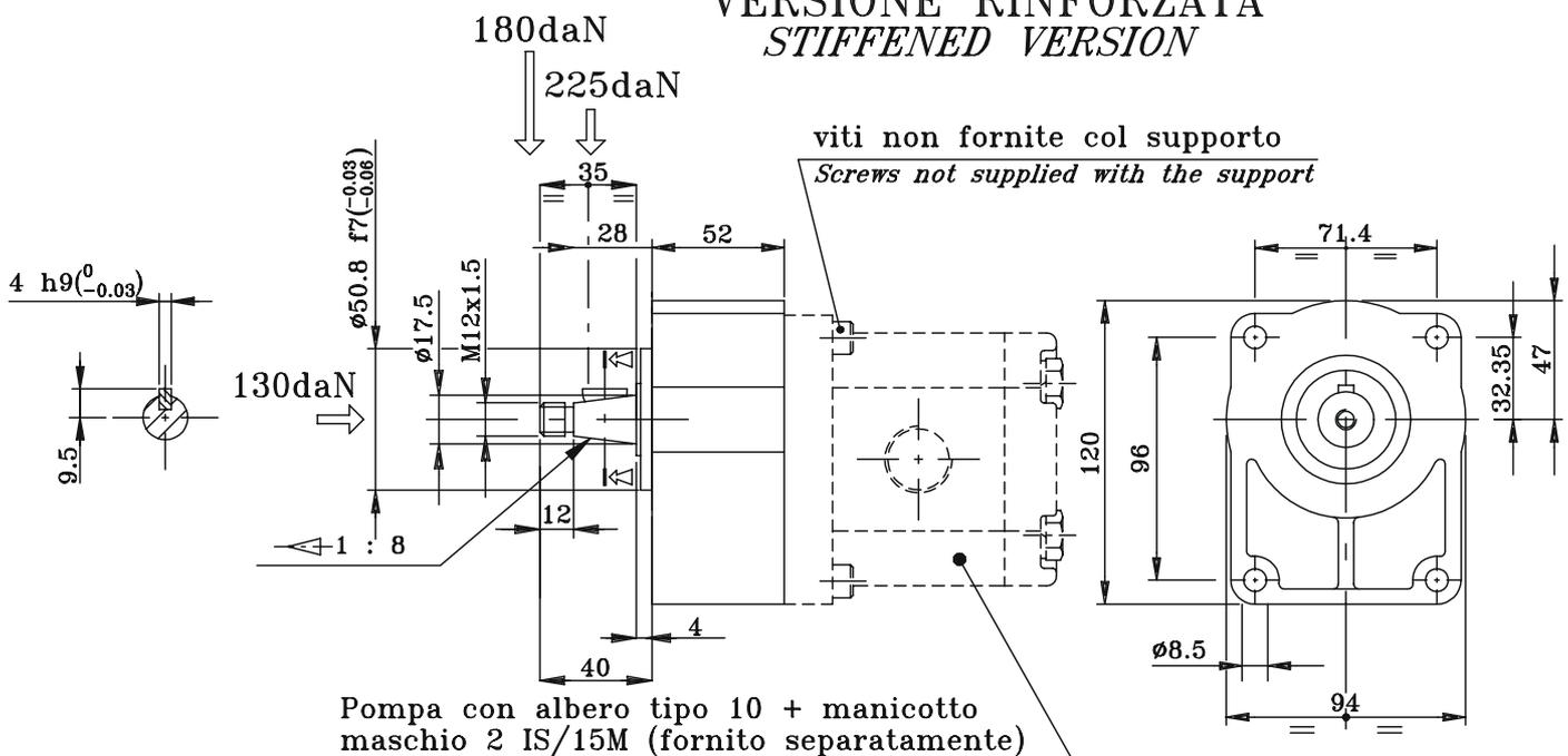
Pompa con albero tipo 10 + manicotto maschio 2 IS/15M (fornito separatamente)
