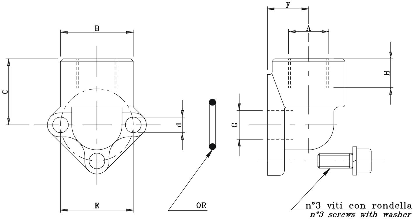
**RACCORDI A GOMITO IN ACCIAIO ( Per connessioni tipo "N" )**
