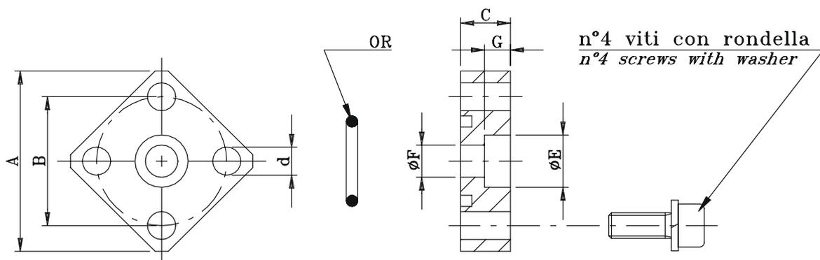
**FLANGE DI ATTACCO DIRITTE SALDABILI (per connessioni tipo "N")**
